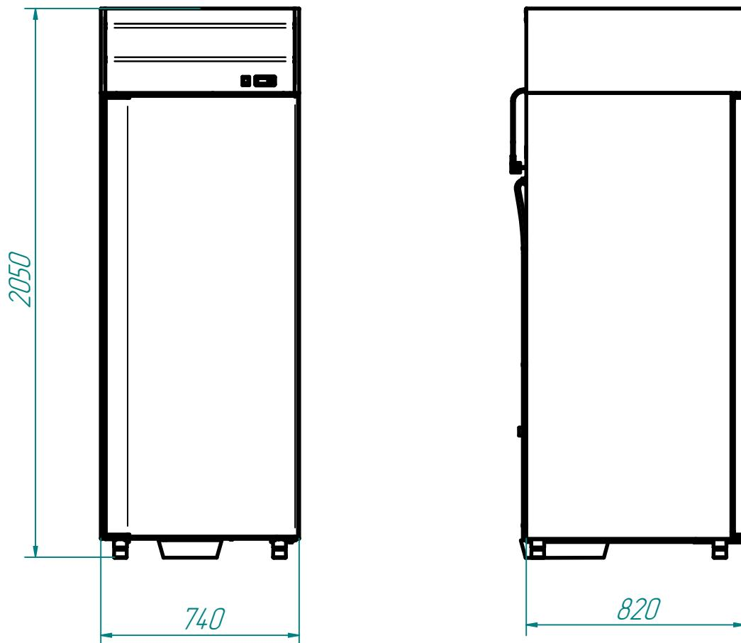
Шкаф холодильный типа ШХ-0,7 (ШХн-0,7;ШХс-0,7) с верхним расположением агрегата предназначен для хранения пищевых продуктов в охлаждённом или замороженном состоянии на предприятиях общественного питания и торговли.
