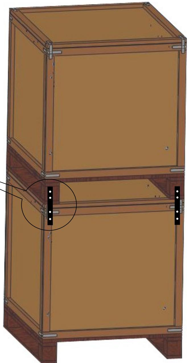
Для транспортировки оборудования упакованного в коробки из ДВП необходимо сбить упаковки между собой с помощью металлической ленты и гвоздей с четырех сторон как показано на рисунке.
