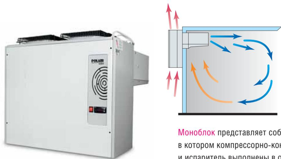
**Моноблок** представляет собой единую конструкцию, в котором компрессорно-конденсаторный блок и испаритель выполнены в одном корпусе. Устанавливается в верхней части стены холодильной камеры.
