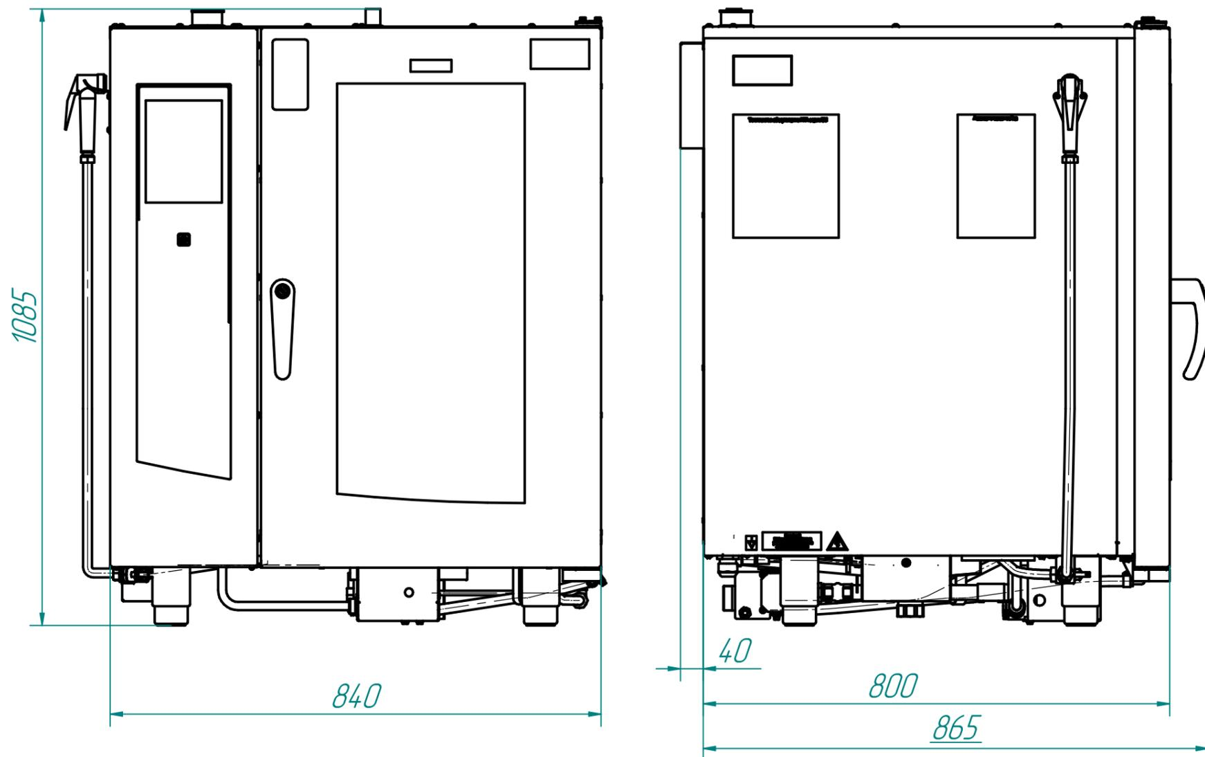
Пароконвектомат предназначен для приготовления различных блюд как в ручном режиме, так и с использованием **готовых программ приготовления**. Встроенная функция **автоматической мойки** позволит быстро и качественно очистить камеру без участия человека. Мойка возможна как жидкими моющими средствами, так и таблетизированными средствами.
