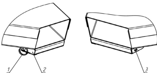
**ВНИМАНИЕ!** Не допускается эксплуатация установки без фиксации защелки шплинтом!
