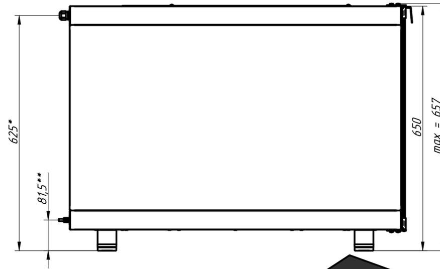
Шкаф расстоечный тепловой типа ШРТ предназначен для расстойки мелкоштучных хлебобулочных и кондитерских изделий на предприятиях общественного питания. Основной режим работы - расстойка продукта при температуре 45° С. Шкаф может использоваться на предприятиях общественного питания как самостоятельно, так и в составе технологической линии.
