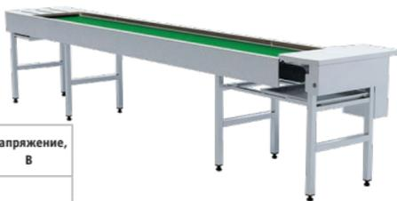
применена конвейерная лента, состоящая из тканевого основания, верхнего слоя из ПВХ и одной тканевой прокладки.
